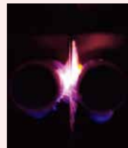
中央を落下する食塩水の左右両側に形成された放電プラズマ。食塩水が通ることで、その周りに放電が発生している。
