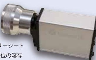
日本での導入事例がまだ数台という、非接触センサーシートを用いた酸素計で、測定部位の溶存酸素やpHの2Dイメージングが可能です。
