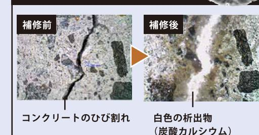
試験結果から納豆菌の代謝によって炭酸カルシウムが析出し、ひび割れが閉塞していることが分かります。補修後、透水試験を行った結果、すべての試験用コンクリート部材（ひび割れ幅約0.2～0.4mmの範囲）において、高い止水効果が得られています。
