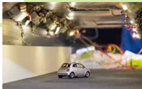
1/24 の模型を使ったトンネル照明の実験
