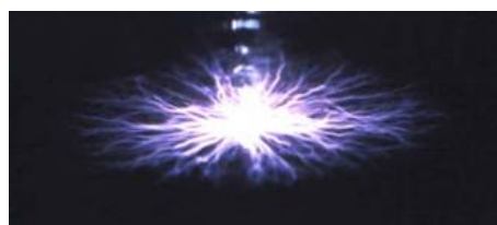
図 1. 水上沿面放電の静止写真
