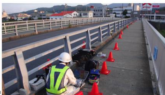
5 径間コンクリート橋の全径間同時振動測定
