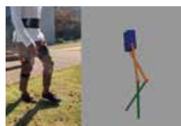
人工知能を用いて下半身に装着した単一慣性センサから歩行動作中の関節角度を推定
