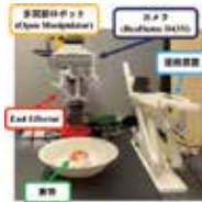
図2.食事支援ロボットシステム [食事支援ロボットシステム] 爪楊枝による突き刺し動作を行うロボットマニピュレータと、スプーンによる差し出し動作を行う多関節ロボットを有する食事支援ロボットシステム。
