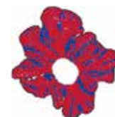
図. 水素予混合乱流火炎と分子拡散の影響を受け伝ばする火炎面
