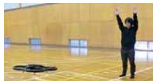
ジェスチャー認識により動作するマルチコプタ・ドローン
