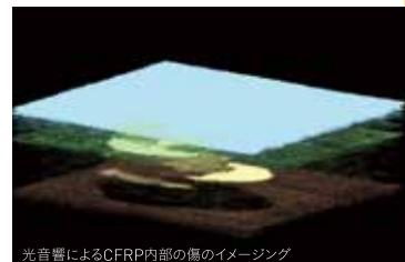
光音響によるCFRP内部の傷のイメージング
