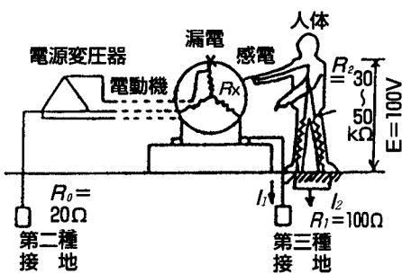
図13-1 漏電危険防止接地（機器接地）
