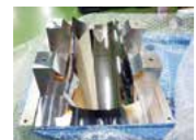
試作されたCFRPミラー 課題①: プリントスルーの抑制 課題②: 長期寸法安定性
