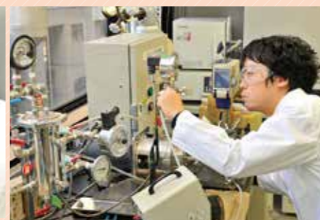
ビーズミルによるナノ微粒子の作製
