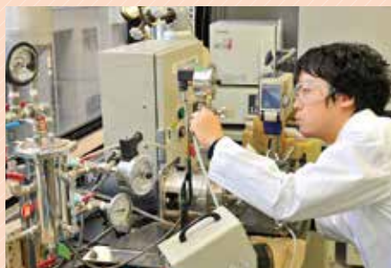
ビーズミルによるナノ微粒子の作製
