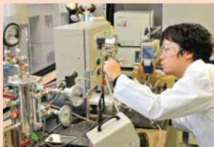
ピーズミルによるナノ微粒子の作製
