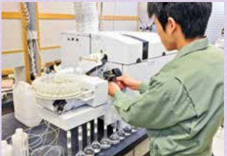
ICP-MSを用いたレアメタルの分離度の測定
