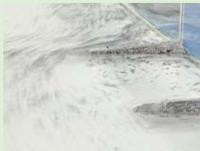
透過型石かご水制模型周辺の流れ
