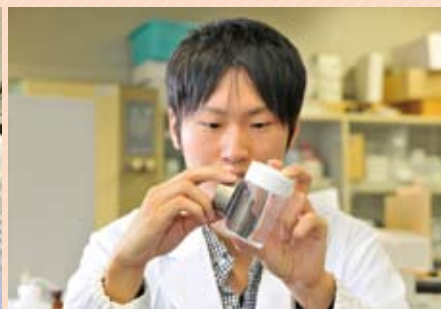
磁石に引き寄せられる複合材料(福島の除染に用いる)
