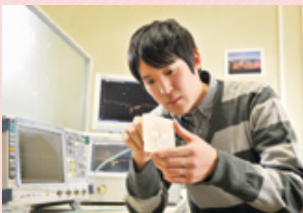
小型平面アンテナとネットワークアナライザ
