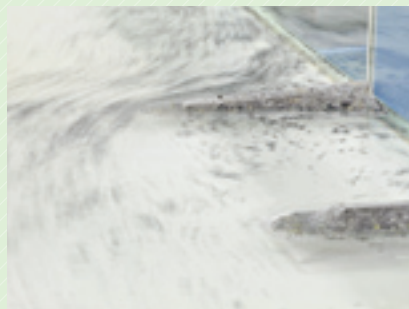
透過型石かご水制模型周辺の流れ
