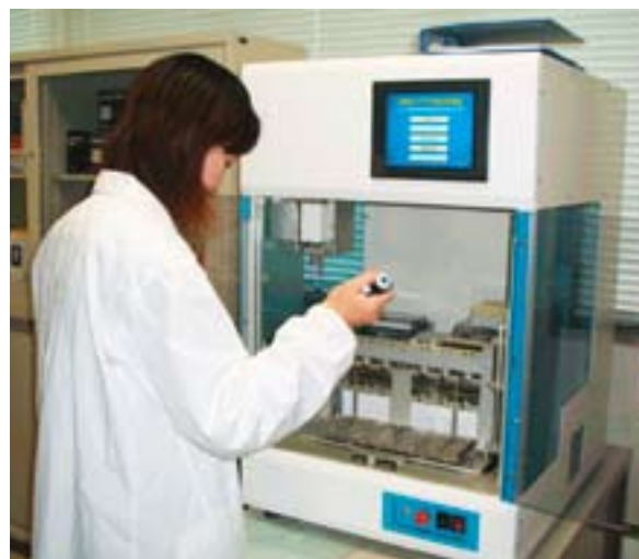
21世紀の新技术「タンパク質を試験管でつくる」、無細胞系タンパク質合成技術(簡易精製機能付き卓上型全自動タンパク質合成機-Protemist DT-)。
