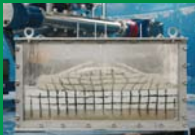
道路盛土の地震時液状化による破壊実験
