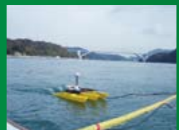
超音波ドブラー流速計を用いた流速と水深の同時計測
