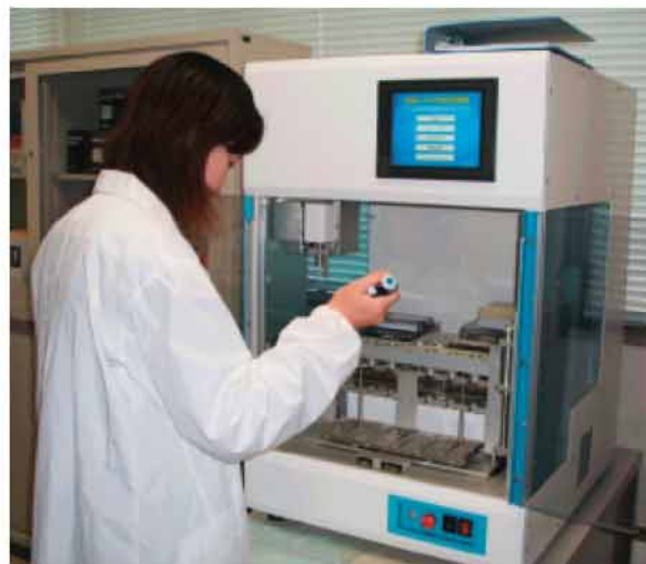
21世紀の新技术「タンパク質を試験管でつくる」、無細胞系タンパク質合成技術（簡易精製機能付き卓上型全自動たんぱく質合成機-Protemist DT-）。
