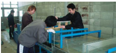
橋脚の安定性に関する模型実験 「水の流れと土砂の動きを再現する」
