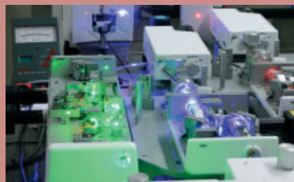
プラズマ計測に使用される最新の波長可変レーザーシステム 左から、緑、紫、赤、の各波長のレーザーが発振しています。これらは最新の技術を使用した波長可変のレーザーです。このように電気電子工学科では最新の機器を使用した研究・教育が活発に行われています。
