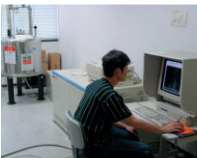
高分解能NMR(核磁気共鳴)装置による有機化合物の構造解析
