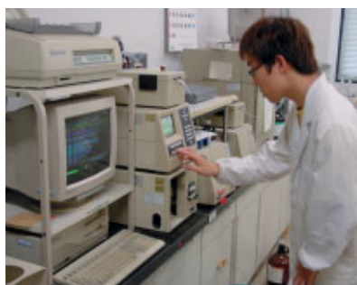
高速液体クロマトグラフによる有機化合物の測定
