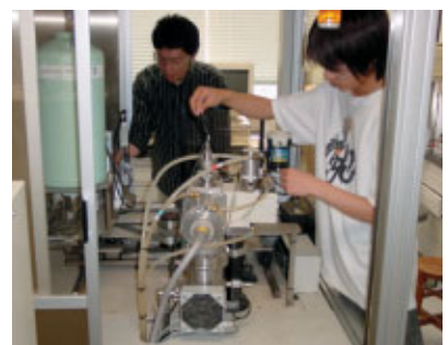
広域X線吸収微細構造解析装置(XAFS)を用いて固体触媒の局所構造を解析する
