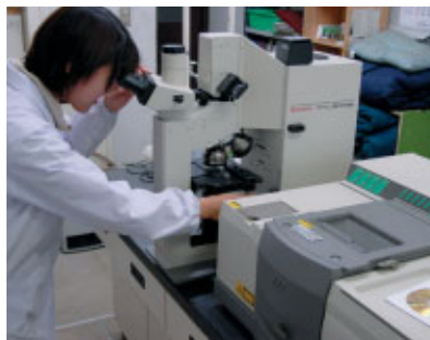
顕微FT-IRによる無機化合物の微小領域の構造解析
