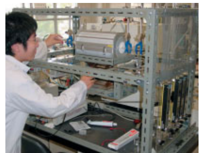
自作燃料電池装置により合成した固体電解質を評価する
