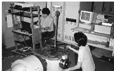
二軸同時動電式振動試験装置による実地震動シミュレーション
