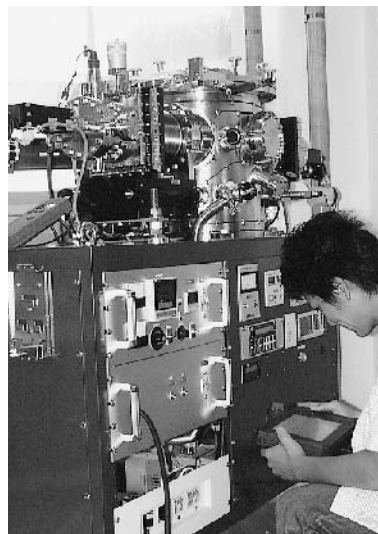
レーザーアブレーションを利用した 薄膜コンデンサ作製装置
