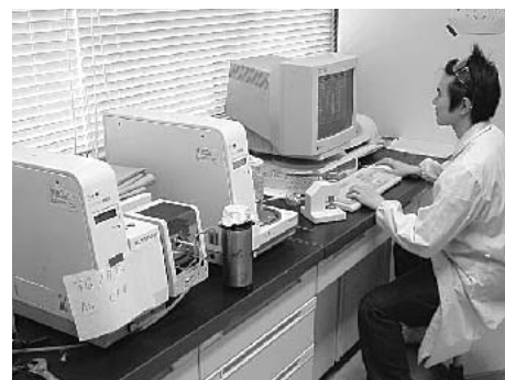
示差走査熱量測定 (DSC) による高分子の熱的特性の解析
