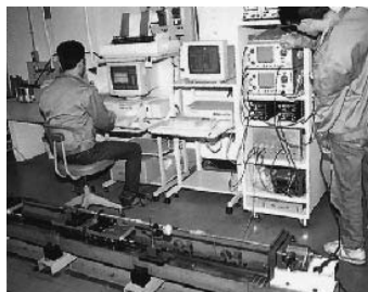
波動伝ばによる複合材料の特性評価実験
