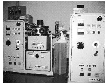
高融点材料の薄膜作製が可能な高周波スパッタ装置
