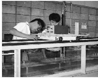
実験水路での河床縦断形状の自動計測
